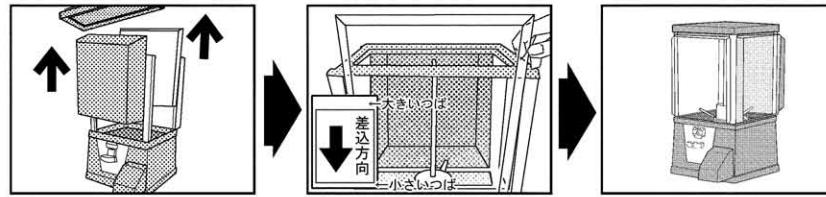
梱包時の形のまま水平な場所に置き、前部と背部のパネルを引き抜きます。
