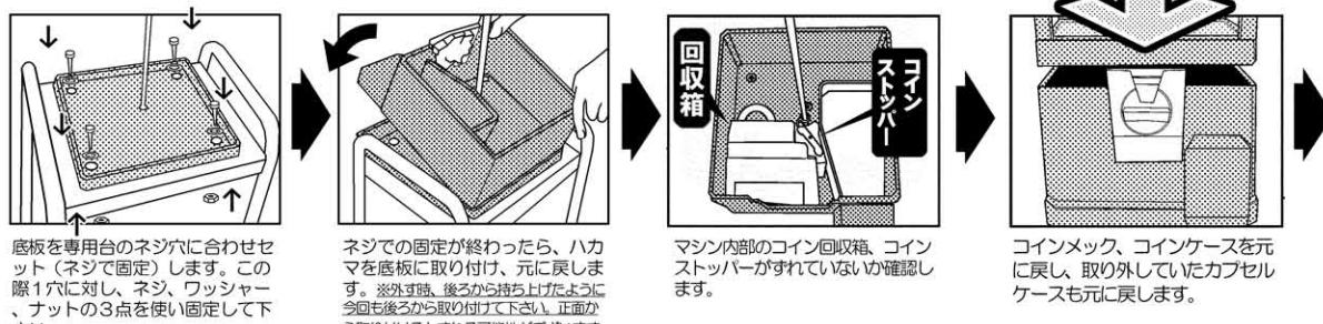
底板を専用台のネジ穴に合わせセット（ネジで固定）します。この際1穴に対し、ネジ、ワッシャー、ナットの3点を使い固定して下さい。
